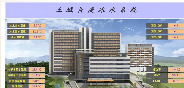
中央空調主機房系統全變頻控制
