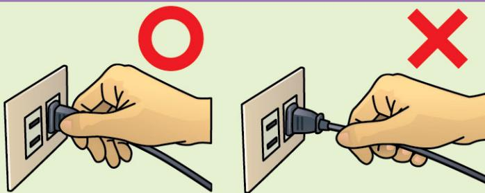
拔下延長線或電器電線時，應手持插頭取下，不可僅拉電線，以免造成電線內部銅線斷裂。
